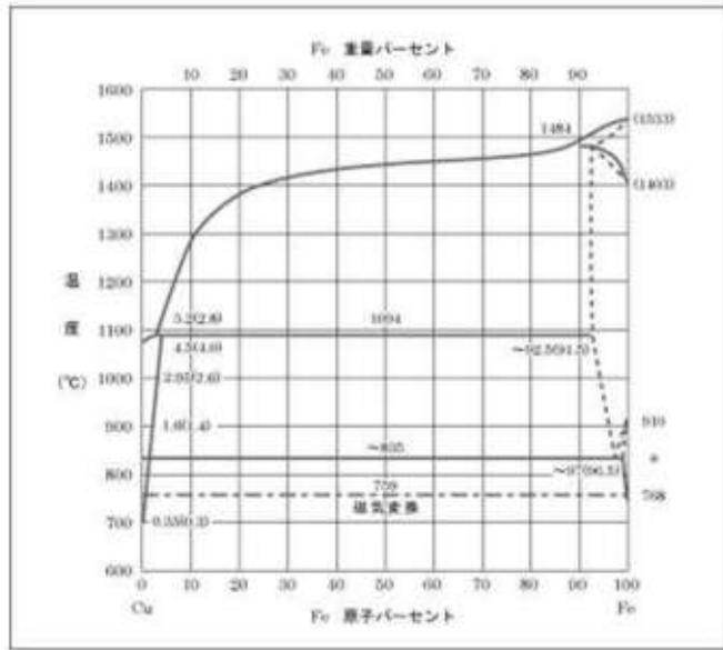
第1図 Cu-Fe<sub>2</sub>π 平衡状態図
