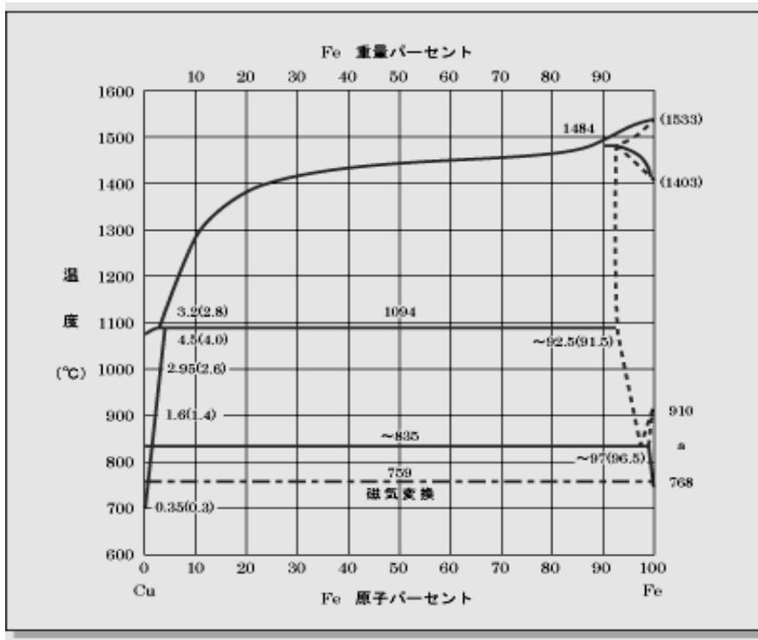
Cu-Fe<sub>2</sub>π 平衡状態図
